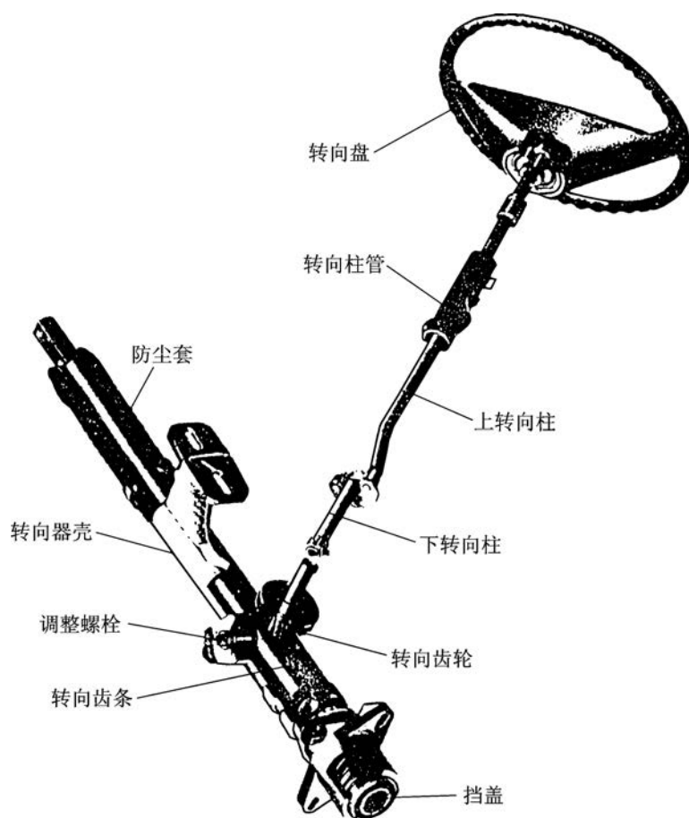
图 3-7 齿轮齿条转向器
