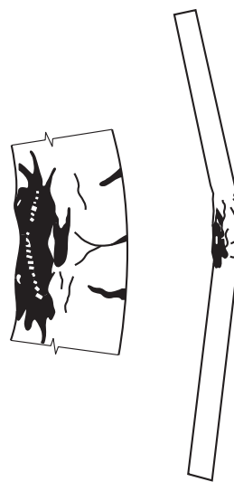
图 3-7 细长轴心受压构件的破坏
