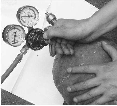
图 3-18 调节氧气的工作压力
