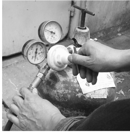
图 3-19 调节乙炔的工作压力
