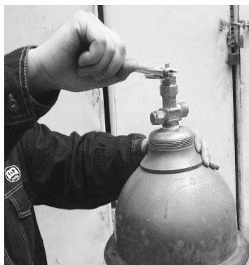
图 3-10 吹除瓶嘴处污物
