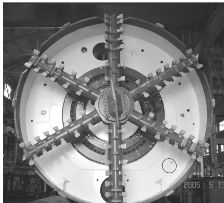
图 3-25 辐条式刀盘(无滚刀)
